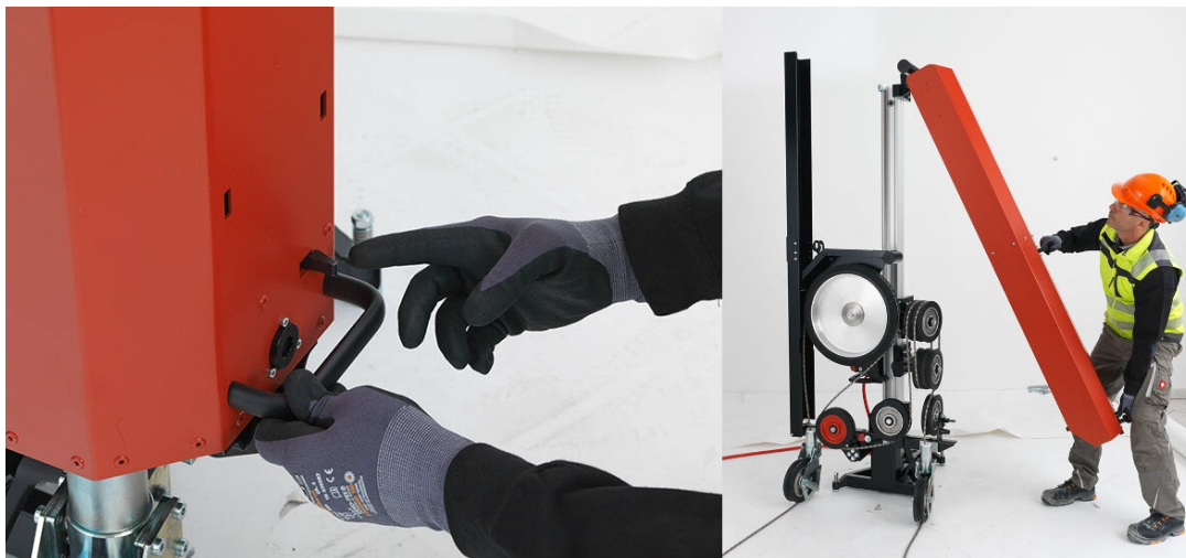
4. 拆下锯绳卷绕装置护罩。
